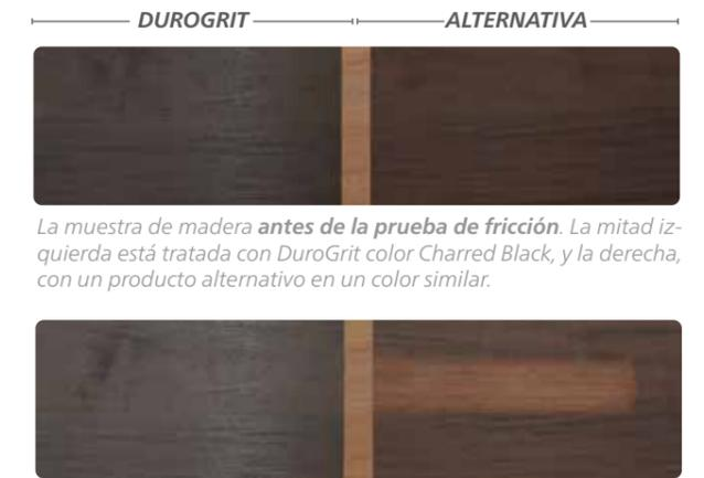
La muestra de madera **antes de la prueba de fricción**. La mitad izquierda está tratada con DuroGrit color Charred Black, y la derecha, con un producto alternativo en un color similar.
