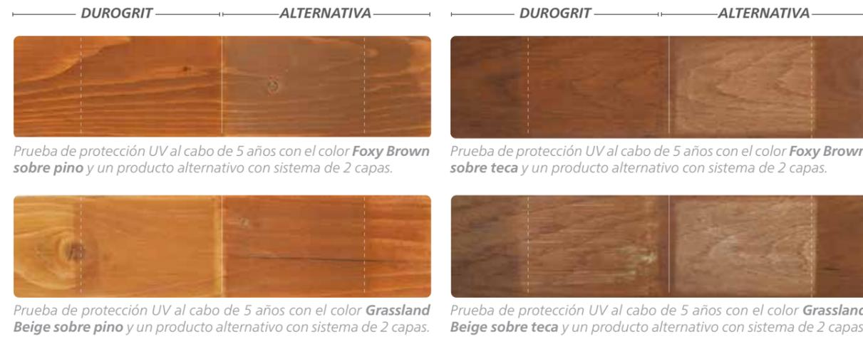
Prueba de protección UV al cabo de 5 años con el color **Foxy Brown** sobre pino y un producto alternativo con sistema de 2 capas.
